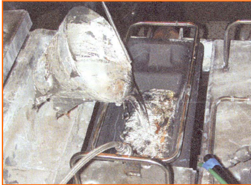
溶湯保護されている溶融マグネシウム 溶湯表面近傍では燃焼が認められない
