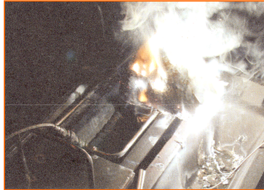
溶湯保護されていない溶融マグネシウム 溶湯表面近傍で著しく燃焼している
